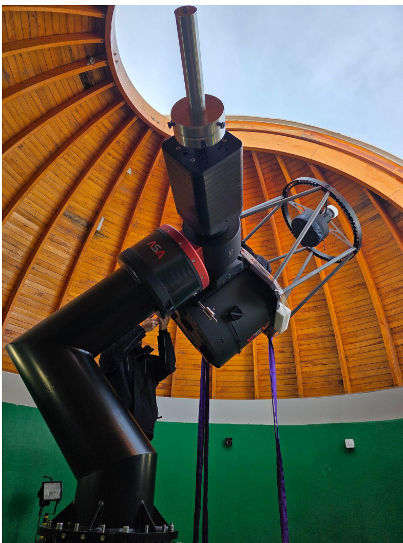
Фиг. 9 Общ вид на новия 80-см телескоп инсталиран в НАО-Рожен
