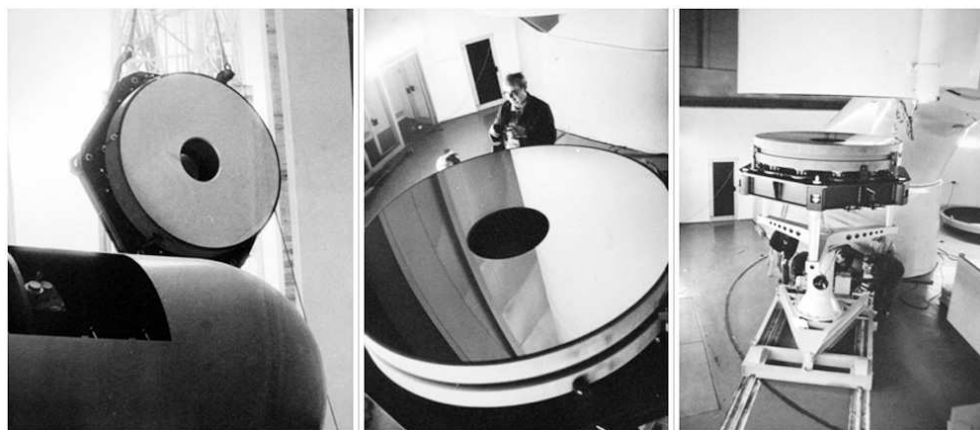
Фиг. 24. Монтаж на главното огледало на 2-м телескоп. (снимки: В. Цинцаров - архив НАО).
