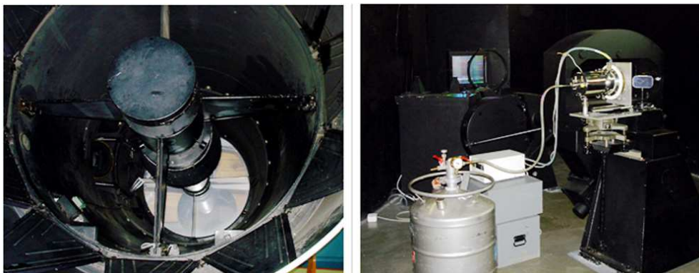
Фиг. 28. Оптиката на 2-м телескоп (вляво) и куде-спектрографът (вдясно) - в дъното е отворената дифракционна решетка, а отпред - дюарът с течен азот и CCD-камерата. (снимки: автора)
