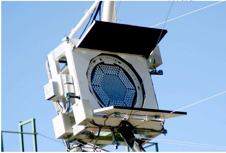
Fig. 11. Регистриращата камера - система от фотоумножители, разположена в фокусната плоскост на рефлектора
