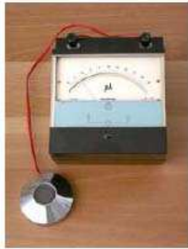
Fig. 3. Уредът за измерване осветеността чрез фототок - микроамперметър и свързана към него фотоклетка
