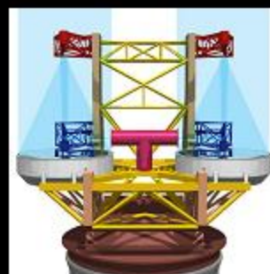
8.4-м огледало за Големия бинокулярен телескоп LBT
